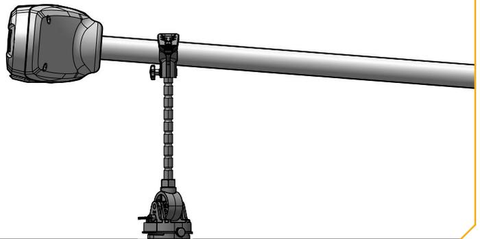
Il pourrait être nécessaire de caler ou modifier le pont ou le plat-bord sous l'emplacement de montage afin de créer une zone plate pour fixer la base.
